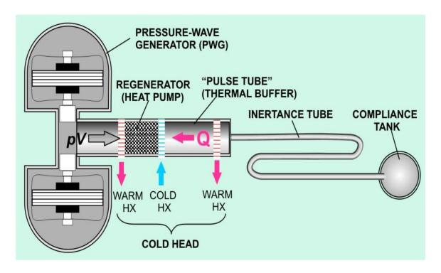
Figure 2: Thermoacoustic (pulse tube) Diagram
